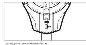
连接电源,拨动开关至ON
